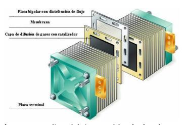
medio tanto ácido como básico) que permite el intercambio de los iones que permiten ambas reacciones. Uniendo cada dos celdas existe un
